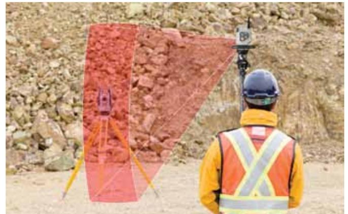
Il sistema RC-PR5 On-Demand consente la ricerca rapida del prisma. Un sensore direzionale incorporato monitora il movimento del prisma in modo da far ruotare l'SX nella direzione (sinistra o destra) più vicina.
